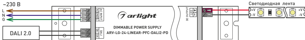
Рис. 1. Подключение источника питания при использовании интерфейса DALI 2.0
