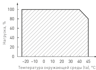
Рис. 6. Максимальная допустимая нагрузка, % от мощности источника
