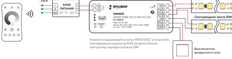
Рис. 1. Схемы подключения диммера SMART-PWM-102-72-MIX-PD-SUF
