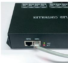
Рис. 2. Подключение контроллера HX-801RC к мастер-контроллеру или компьютеру.
