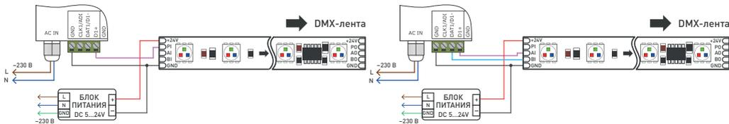
Рисунок 2. Подключение DMX светодиодной ленты к выходу контроллера.
