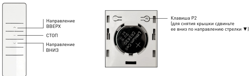
Рис. 7. Пульт управления карнизом для штор
