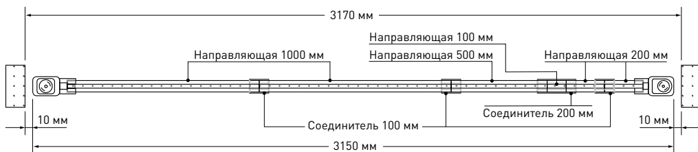
Рис. 3. Пример сборки направляющей длиной 3.15 м
