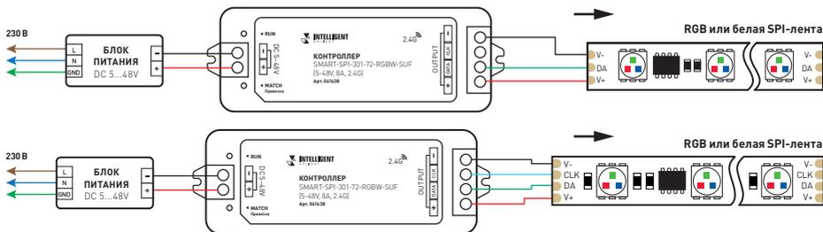
Рис. 3. Схема подключения контроллера SMART-SPI для управления светодиодной лентой SPI
