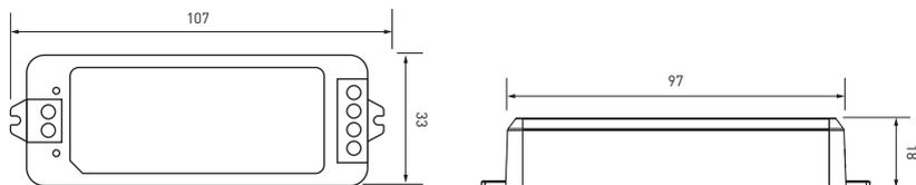
Рис. 1. Габаритные размеры
