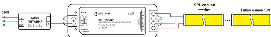
Рис. 4. Схема подключения контроллера SMART-SPI для управления SPI-неоном
